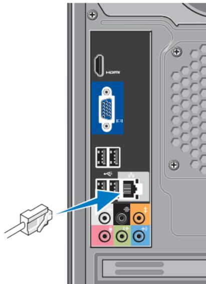
Une connexion réseau n'est pas requise pour installer votre ordinateur. Cependant, si vous avez une connexion réseau ou Internet devant être branchée (p. ex. un câble de modem ou une prise Ethernet), vous pouvez effectuer son branchement maintenant. Veuillez n'utiliser qu'un câble Ethernet (connecteur RJ45). Ne branchez pas de câble téléphonique (connecteur RJ11) au connecteur réseau.
